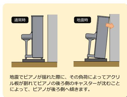
地震でピアノが揺れた際に、その負荷によってアクリル板が割れてピアノの後ろ側のキャスターが沈むことによって、ピアノが後ろ側へ傾きます。
